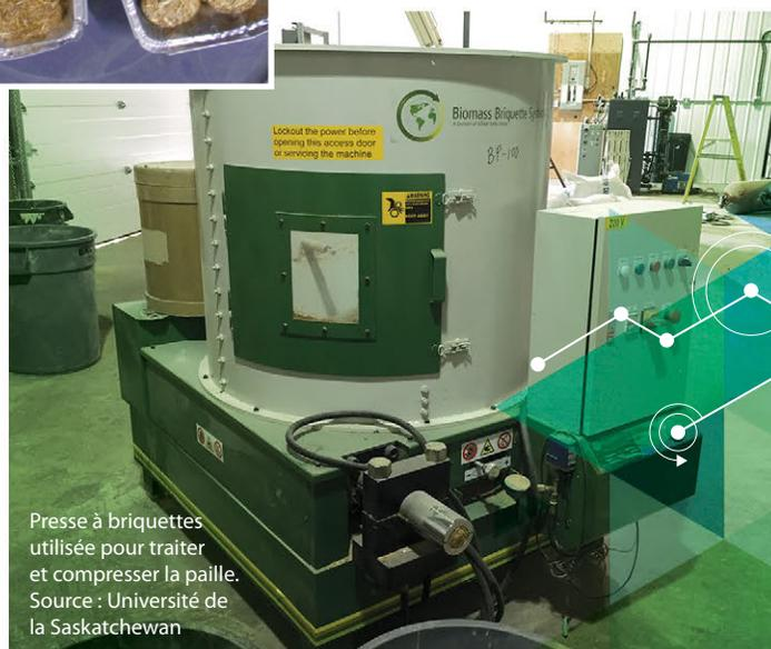
Presse à briquettes utilisée pour traiter et compresser la paille.
