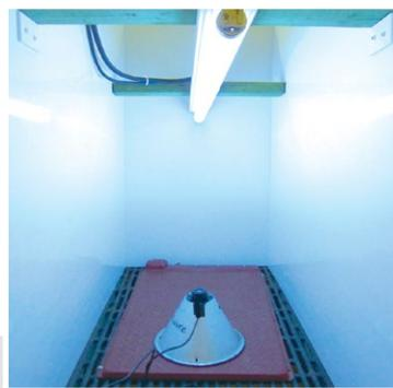
Station permettant d'exposer les porcelets à des radiations UV, lesquelles sont mesurées en installant un appareil à côté du porcelet. Source : Centre de recherche et de développement de Sherbrooke, AAC
