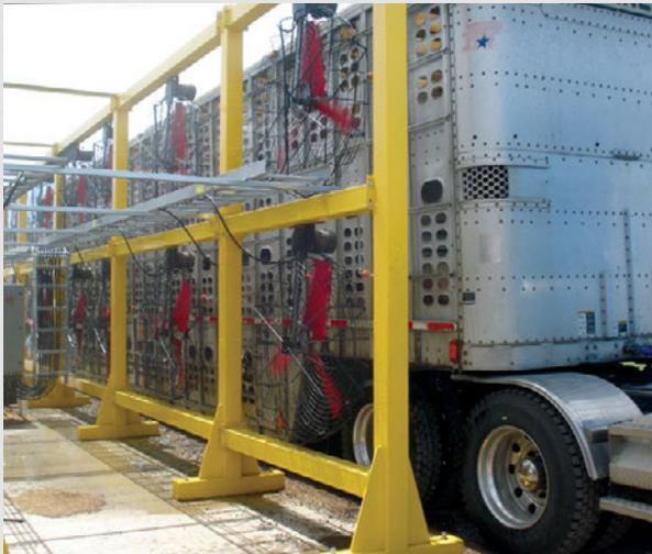
Système de ventilation. Source : Centre de recherche et de développement sur le bovin laitier et le porc, AAC
