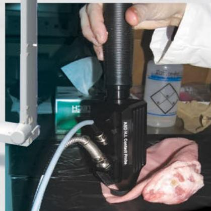
Spectroscopie de réflexion dans le domaine du proche infrarouge.
