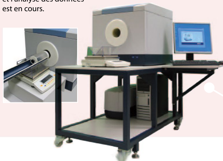
Équipement de résonance magnétique nucléaire (RMN). Source : AAC
