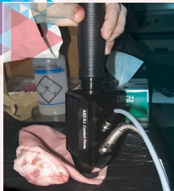
Spectroscopie de réflexion dans le domaine du proche infrarouge (SRIR). Source : AAC
