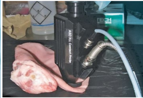
Spectroscopie par réflectance dans le proche infrarouge (SRPI). Source : AAC
