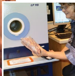
Appareil de résonance magnétique nucléaire. Source : CCAP
