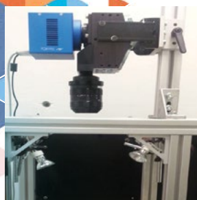
Système d'imagerie hyperspectrale à balayage linéaire. Source : CCAP
