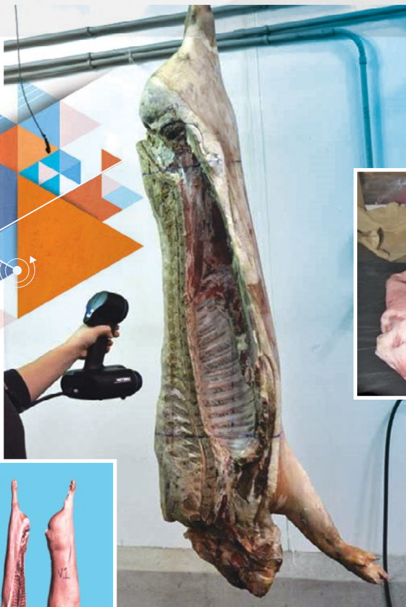
Numériseur 3D portable et modèles de carcasses en 3D. Source : AAC
