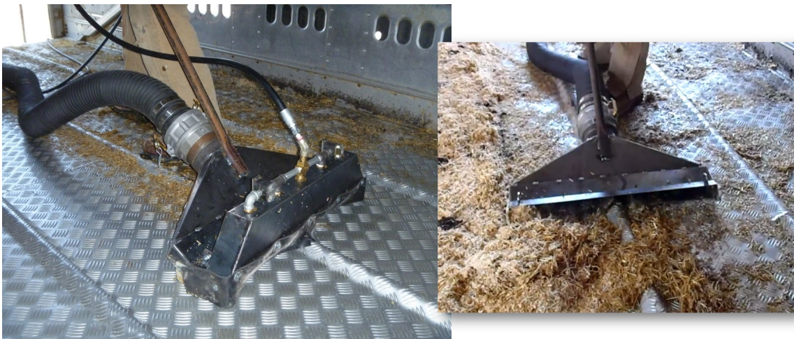
Second passage avec dispensateur d'eau pour réaliser un lavage à pression en combinaison avec un aspirateur (gauche). Nettoyage par aspiration à sec du plancher de la remorque (droit). Source : Prairie Agricultural Machinery Institute
