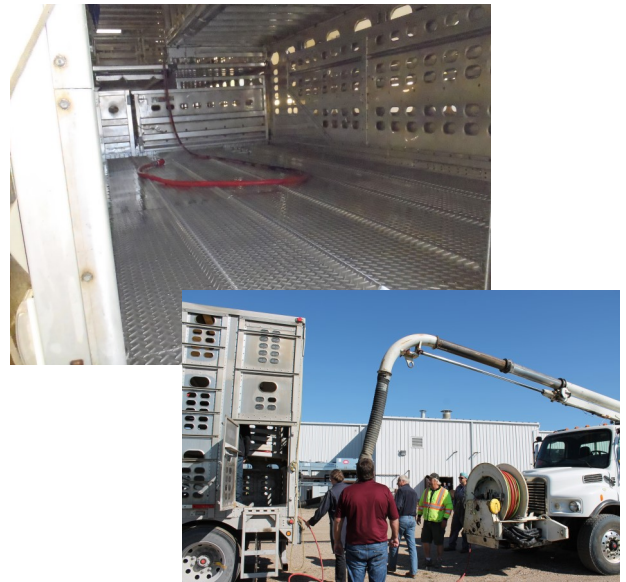
Plancher du camion suite au lavage (haut). Équipements utilisés pour le lavage des camions (bas). Source : Prairie Agricultural Machinery Institute
