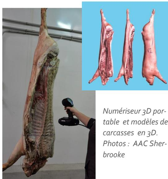
*Numériseur 3D portable et modèles de carcasses en 3D.
