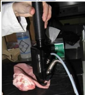
Utilisation de la spectroscopie dans le proche infrarouge sur les oreilles de porcs. Photos : AAFC
