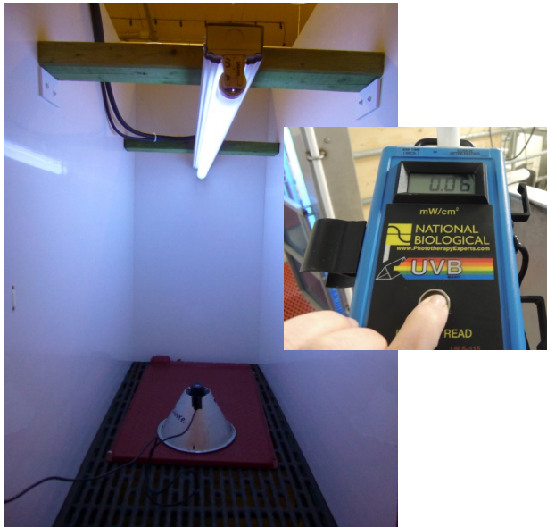
Station permettant d'exposer les porcelets à des rayons UV (gauche) . Dosimètre pour les rayons UVB (droite) . Photos : AAC Centre de la recherche et du développement de Sherbrooke
