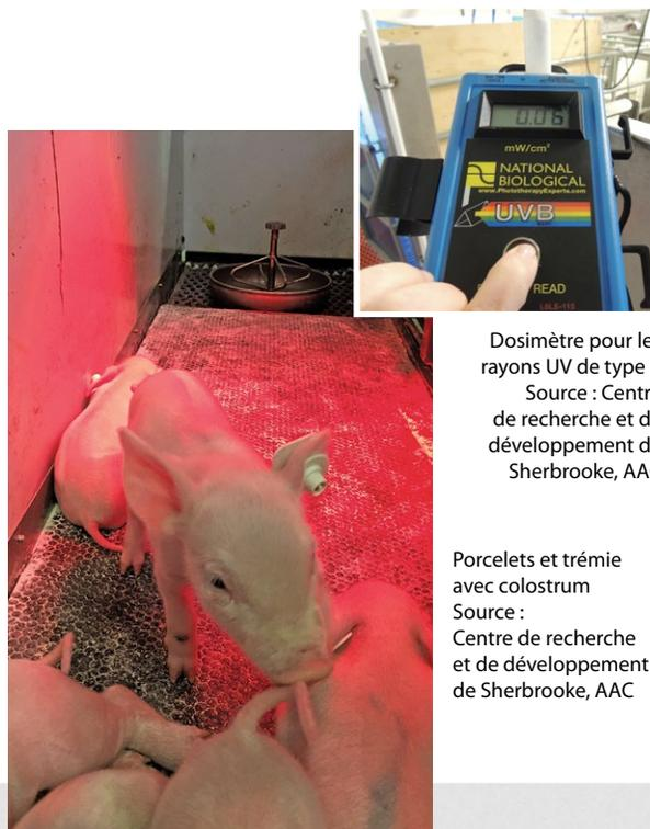
Dosimètre pour les rayons UV de type B
