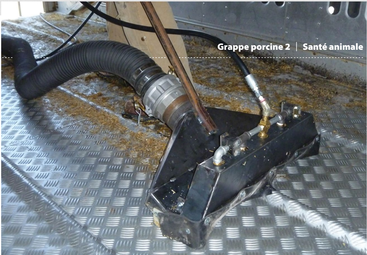
Second passage avec dispensateur d'eau pour réaliser un lavage à pression en combinaison avec un aspirateur Source : PAMI
